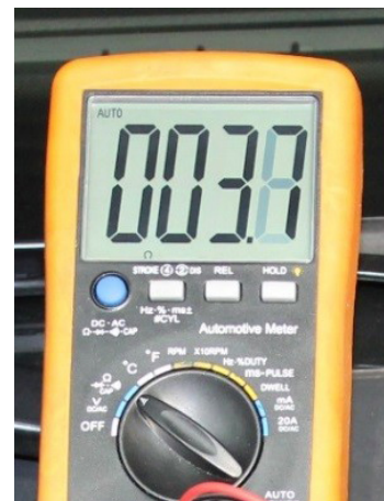
Rezistență a circuitului de încălzire
