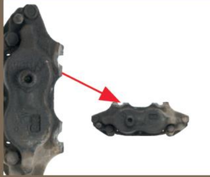
Picioarușe de montare deteriorate
