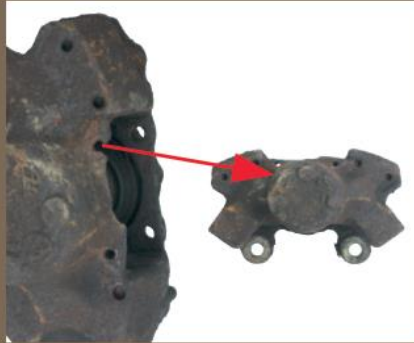
Orificii plăcuță rupte
