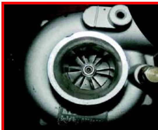
Figura 3 – Carcasa originala gravata ulterior (nu de fabrica) sau turbosuflyantele avand carcase contrafacute (chinezești)
